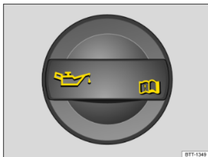
איור 2: בתא המנוע: מכסה פתח מילוי שמן מנוע
