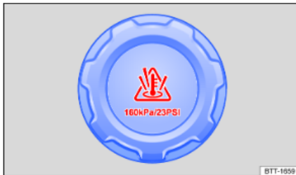
איור 2: בתא המנוע: מכסה מיכל מאגר נוזל קירור
