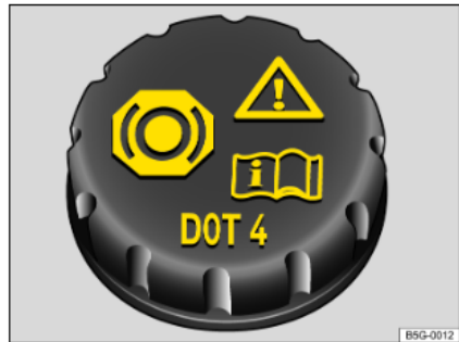
איור 1: בתא המנוע: מכסה מאגר נוזל הבלם
