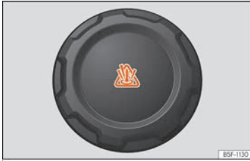
איור: בתא המנוע: מכסה מיכל התפשטות נוזל הקירור
