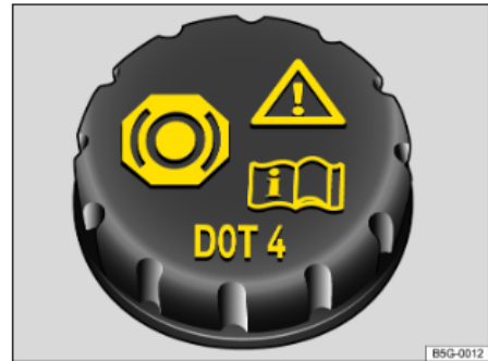
איור 1: בתא המנוע: מכסה מאגר נוזל הבלם
